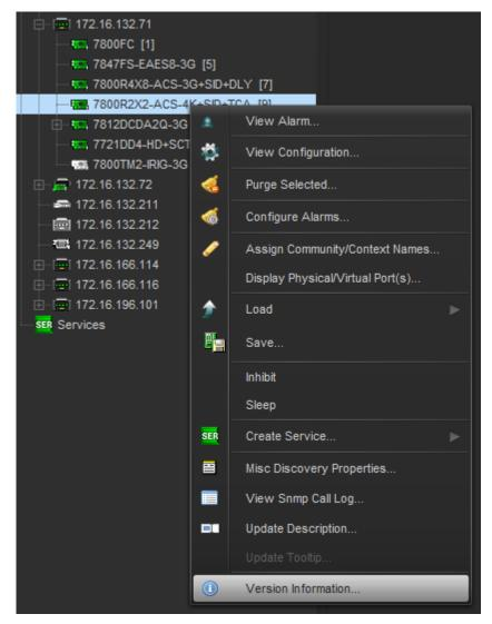
Figure 7-2: VistaLINK® PRO - Module Dropdown Menu
